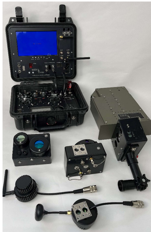
Complete NM 4 set geassembleerd en gereed voor gebruik. Op de foto: control unit, main unit (groen) en de afzonderlijke modules: elektro-optische sensors, akoestische sensors, thermal/infrarood sensors/camera module en UHD-camera module. Alleen de mast ontbreekt nog.
