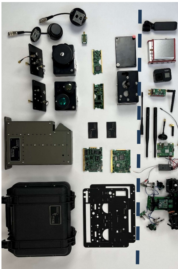
Complete NM 4 set in onderdelen. De PCBA's (printplaten - de elektronica) en behuizingen links van de blauwe (gestreepte) lijn zijn allemaal zelf ontworpen, ontwikkeld en gebouwd. Alleen de koffer is een koopdeel (wel aangepast) en doet dienst als, onverwoestbare, behuizing voor de control unit. De software/code die op die PCBA's draait is ook zelf ontwikkeld. Rechts van de blauwe lijn de koopdelen. De code op de Raspberry Pi minicomputer (ook rechts, voor de kenner) is, uiteraard, ook zelf geschreven.
